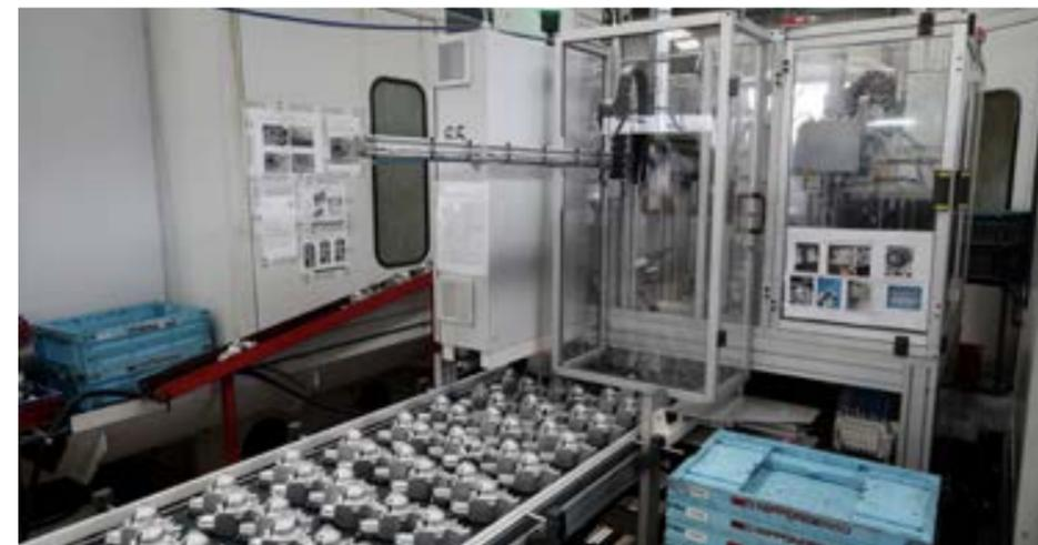
■ Tonsfer, macchina per assemblaggio automatico di guarnizione e cuscinetto
